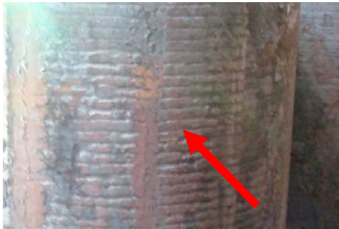
Fig.5.11 Urme de oscilație pe suprafața semifabricatului
