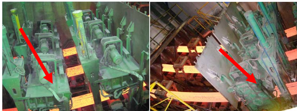
Fig.5.16 Căja de extragere-îndreptare echipată cu role de extragere
