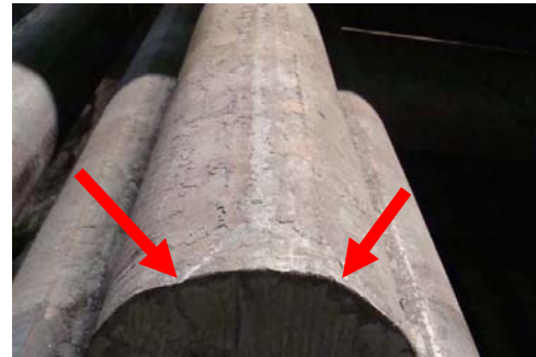
Fig.5.12 Defecte de formă și abateri dimensionale
