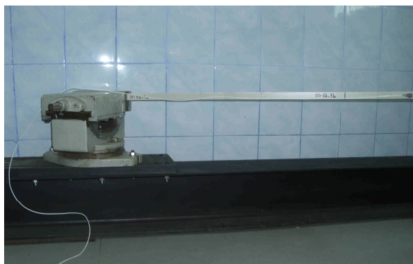
Figura. 5.1. Stand pentru măsurători de frecvențe proprii la bare încastrate
