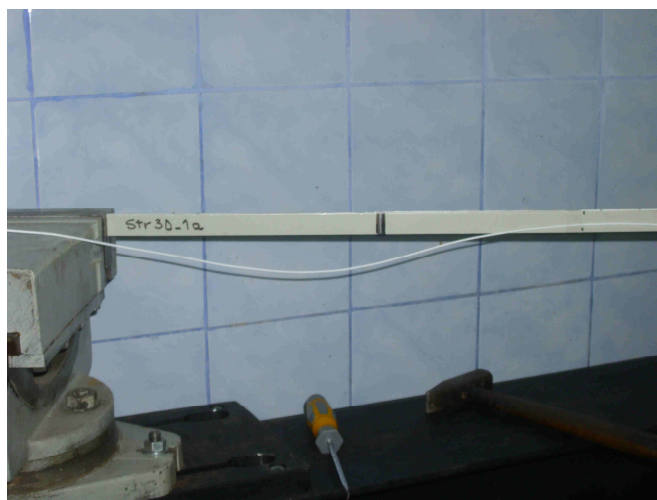
Figura. 5.9. Grinda Str3D_1a cu defectul la 274 mm de încastrare
