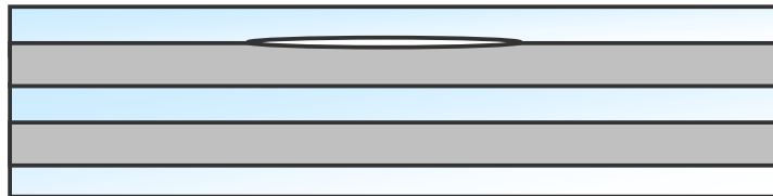
Figura. 2.14. Apariția unui defect (delaminare) într-un compozit stratificat
