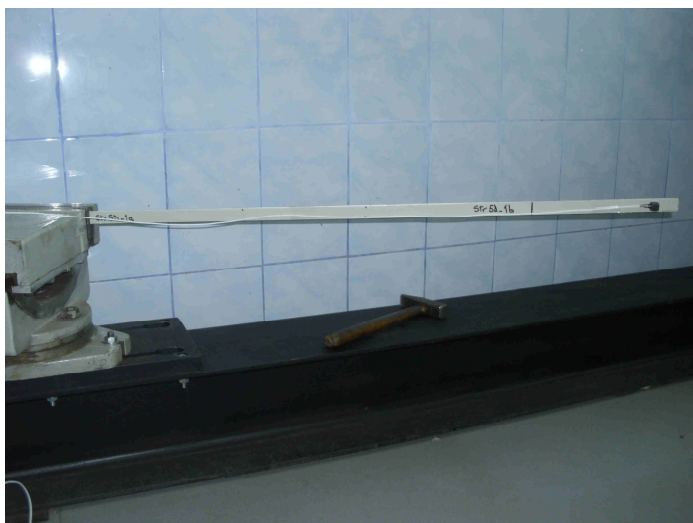
Figura 5.8. Grindă cu marcaj pregătită în vederea măsurării
