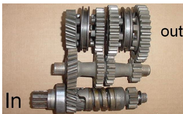
Fig. 2.4 Aplicații ale îmbinărilor cu strângere – fixarea roților dințate [W12]
