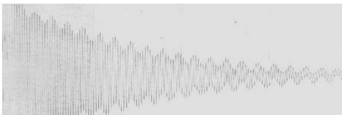
Fig. 6.10 Varianta IV Osie liberă. Traductorul de accelerație pe roata parte antrenată . Impuls pe coroană
