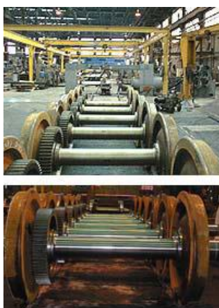
Fig. 2.4 Aplicații ale îmbinărilor cu strângere – fixarea roților dințate [W12]
