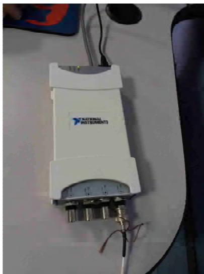
Figura 3.2.6. Sistem compact de transmitere date ENET-9163
