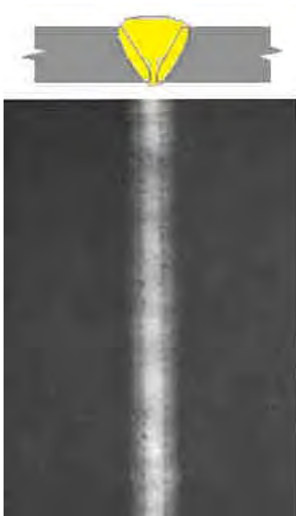
Figura 2.4.2. Model și defecte apărute datorită lipsei de pătrundere
