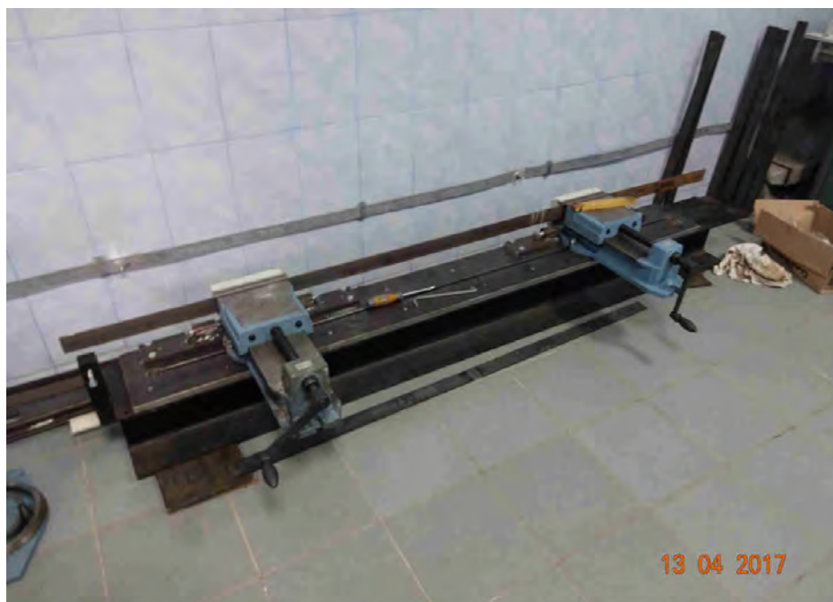
Figura 3.3.1. Măsurare frecvențe naturale la bara intactă
