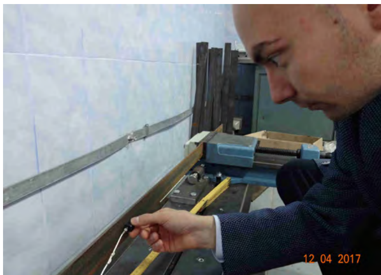
Figura 3.2.4. Lipire accelerometru pe bară
