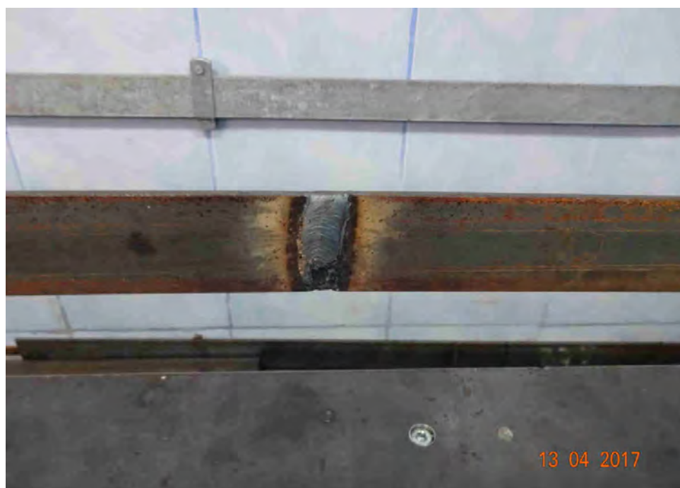
Figura 3.3.4. Măsurare frecvențe naturale la bara sudată pe ambele fețe
