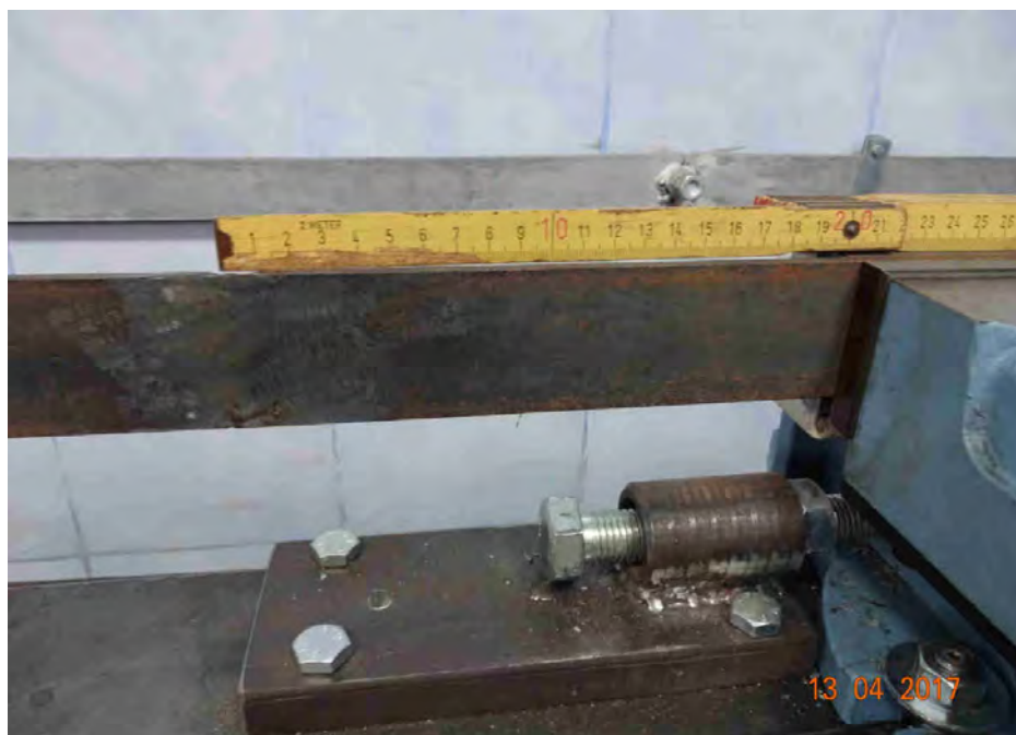
Figura 3.3.6. Măsurare frecvențe naturale la bara sudată prelucrată pe ambele fețe
