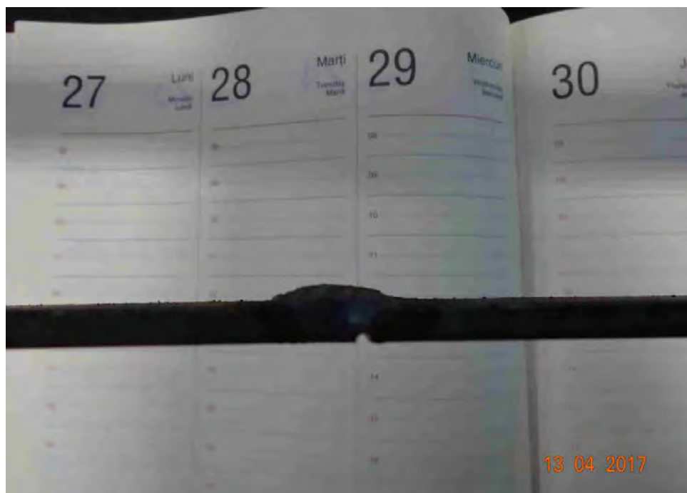
Figura 3.3.3. Bara sudată cu defect - necompletare la rădăcina sudurii
