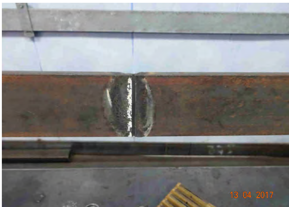
Figura 3.3.2. Măsurare frecvențe naturale la bara sudată cu defect
