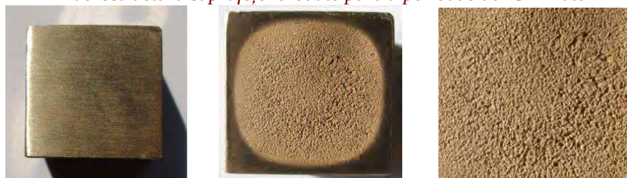
Fig. 5.113 Imagini ale epruvetei înainte de cavitație, după cavitație și macrostructura suprafeței erodate pentru perioade de 30 minute
