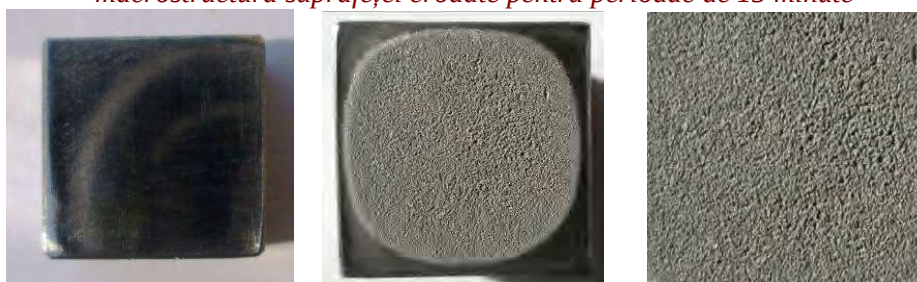
Fig. 5.129 Imagini ale epruvetei înainte de cavitație, după cavitație și macrostructura suprafeței erodate pentru perioade de 45 minute
