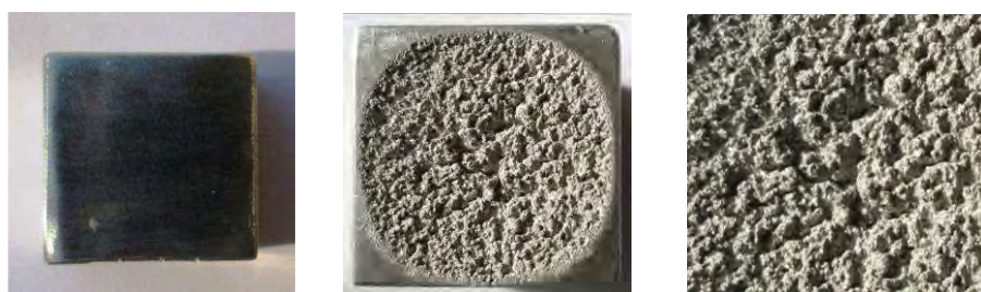
Fig. 5.72 Imagini ale epruvetei înainte de cavitație, după cavitație și macrostructura suprafeței erodate pentru perioade de 15 minute
