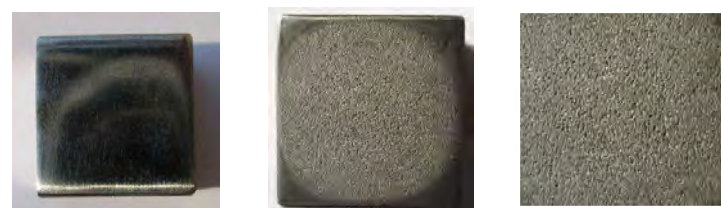
Fig. 5.81 Imagini ale epruvetei înainte de cavitație, după cavitație și macrostructura suprafeței erodate pentru perioade de 30 minute
