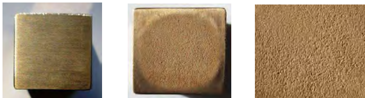
Fig. 5.104 Imagini ale epruvetei înainte de cavitație, după cavitație și macrostructura suprafeței erodate pentru perioade de 15 minute (timp total de 225 minute)
