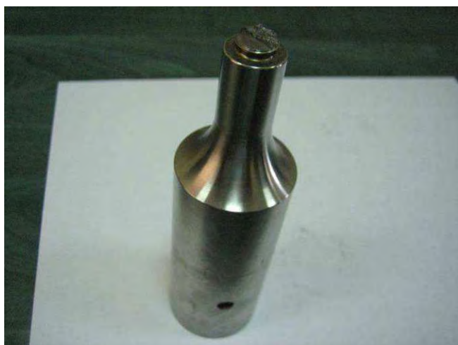
Fig. 4.1 Sonotroda cu filet exterior M12x1 cu ruptură în zona filetului
