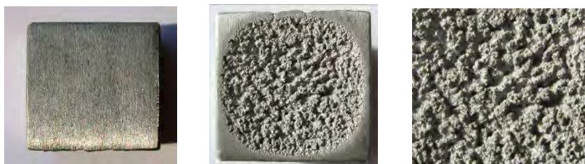
Fig. 5.96 Imagini ale epruvetei înainte de cavitație, după cavitație și macrostructura suprafeței erodate pentru perioade de 15 minute
