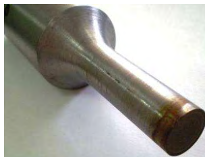
Fig. 4.91 Detalii erodare sonotrodă oțel după mai multe ore de funcționare
