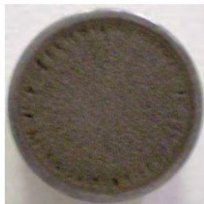
Fig. 4.89 Suprafața erodată a epruvetei din oțel
