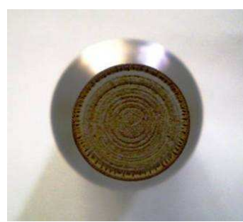
Fig. 4.91 Detalii erodare sonotrodă oțel după mai multe ore de funcționare
