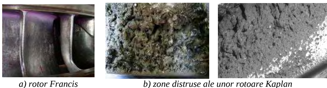
Fig. 1.2 Exemple de rotoare distruse prin cavitație
