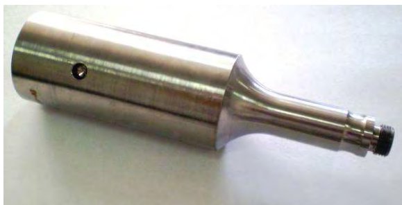
Fig. 4.103 Sonotrodă originală din titan cu filet exterior M12x1 utilizată pentru metoda directă
