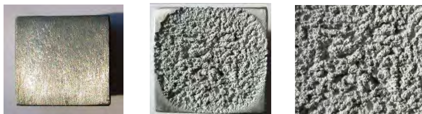
Fig. 5.97 Imagini ale epruvetei înainte de cavitație, după cavitație și macrostructura suprafeței erodate pentru perioade de 8 minute
