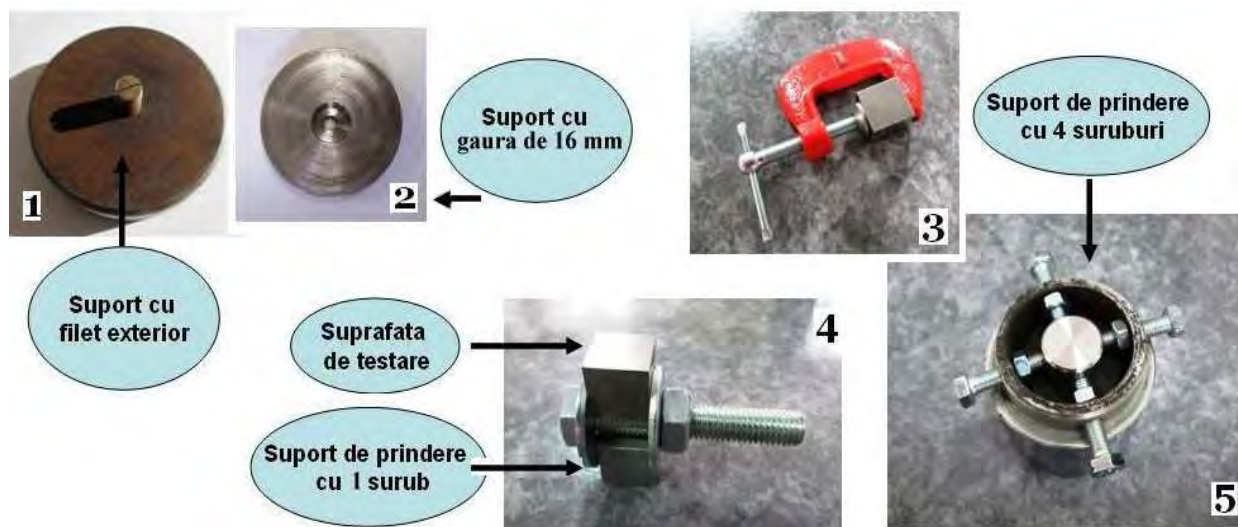
Fig. 3.13 Suporturi pentru fixarea epruvetelor pentru de metoda de eroziune indirectă
