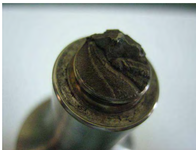
Fig. 4.2 Sonotroda cu filet exterior M12x1 cu ruptură în zona filetului (detaliu)
