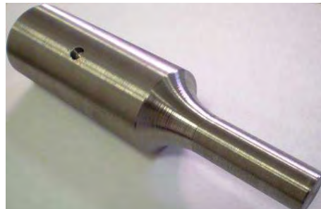
Fig. 4.104 Sonotrodă finală din titan utilizată pentru metoda indirectă
