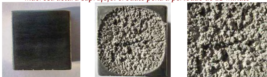
Fig. 5.73 Imagini ale epruvetei înainte de cavitație, după cavitație și macrostructura suprafeței erodate pentru perioade de 5 minute
