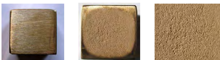
Fig. 5.105 Imagini ale epruvetei înainte de cavitație, după cavitație și macrostructura suprafeței erodate pentru perioade de 30 minute (timp total de 240 minute)
