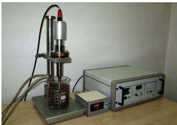
Fig. 3.1 Ștand pentru încercarea eroziunii cavitaționale
