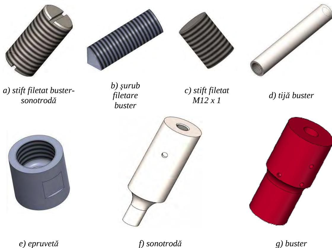
Fig. 4.43.b Elemente componente ale ansamblului 3D buster-sonotrodă-epruvetă
