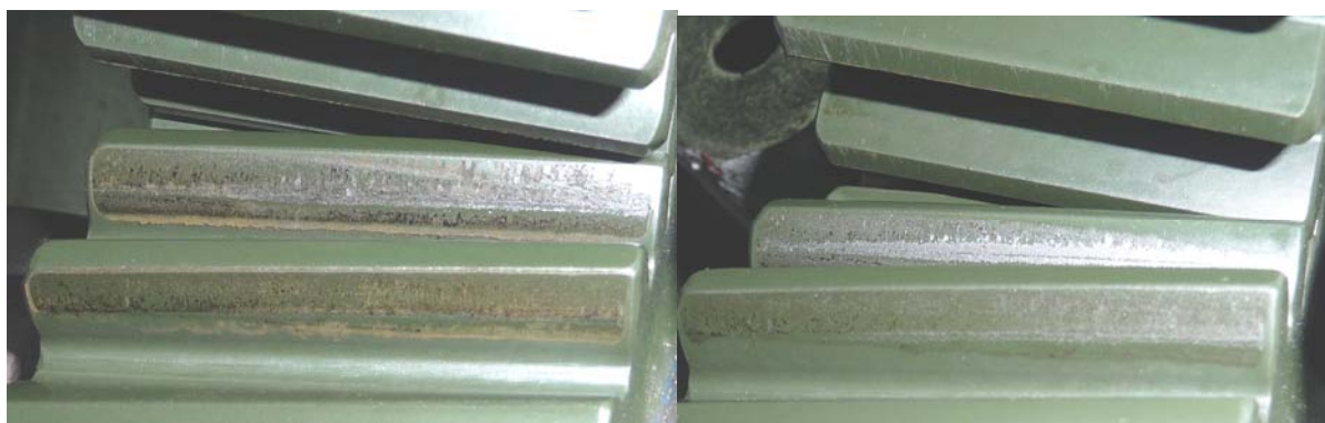
Figura 6.15 Aspectul flancului și materialului de acoperire după creșterea încărcării și vitezei
