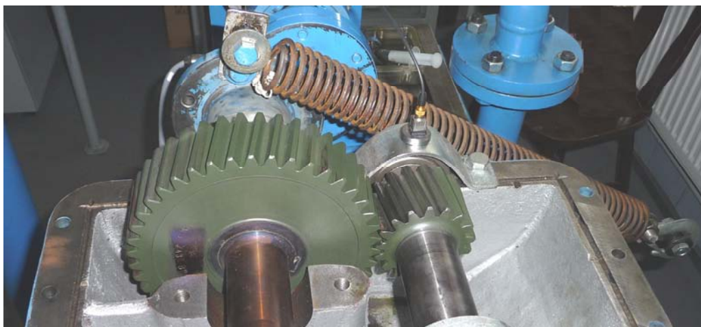
Figura 6.24 Locul de amplasare al senzorului piezoelectric triaxial
