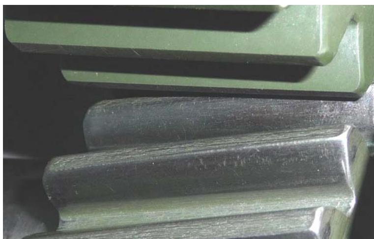
Figura 6.19 Angrenarea între flancurile neacoperite și acoperite fluoropolimeric
