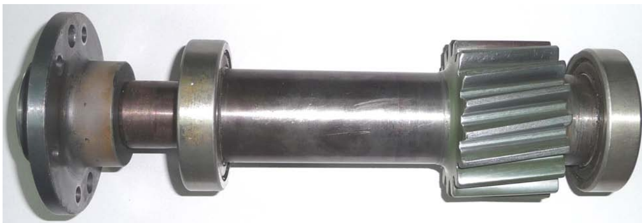
Figura 6.18 Pinionul după îndepărtarea materialului fluoropolimeric uzat de pe flancul a patru dinți
