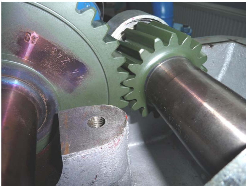
Figura 6.3 Modul de angrenare a dinților în poziția de mijloc a unghiului de oscilație
