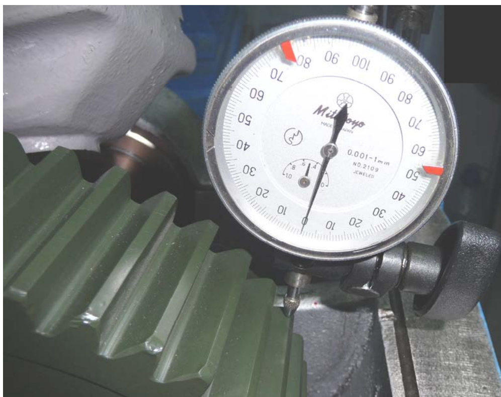
Figura 6.10 Determinarea adâncimii de strivire a materialului de acoperire
