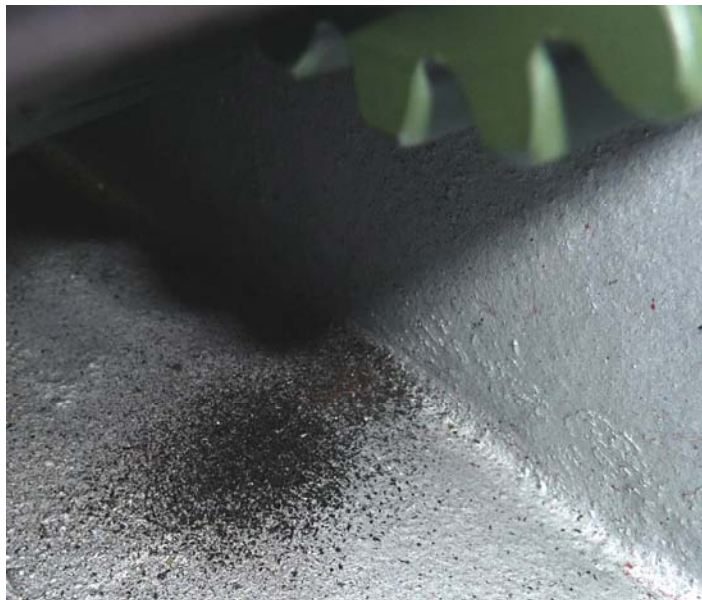
Figura 6.16 Pulbere de culoare neagră situată sub locul angrenării
