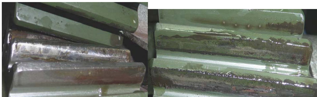
Figura 6.21 Uzarea flancurilor pentru modul de contact mixt la lubrifiere săracă
