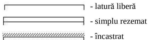
Fig. 1.1. Moduri de prindere a plăcilor
