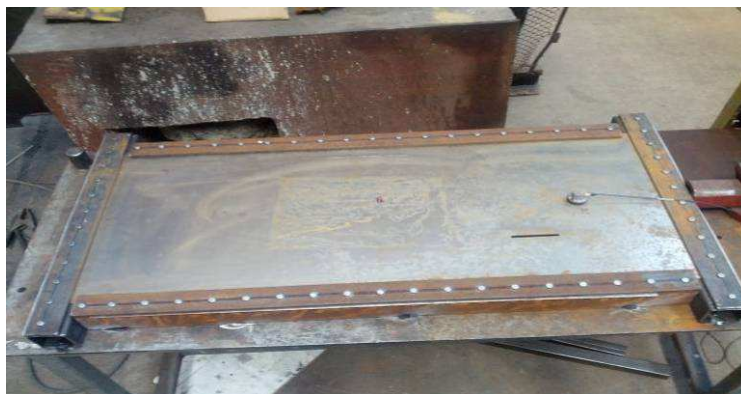
Fig. 4.34. Standul experimental pentru placa ÎÎ-ÎÎ, cu defect central de 5,8×77,5 mm
