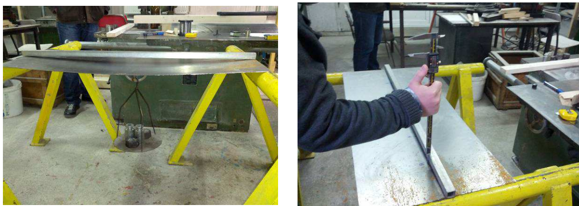
Fig. 4.1 Standul experimental pentru determinarea săgeților
