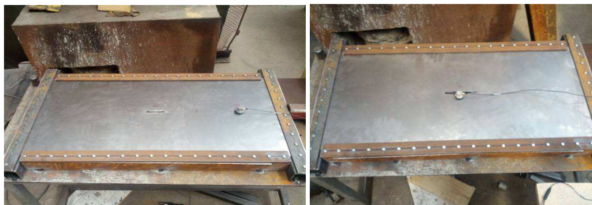
Fig. 4.25. Standul experimental pentru placa ÎÎ-ÎÎ, cu defect central de 4,9 \times 101,6
