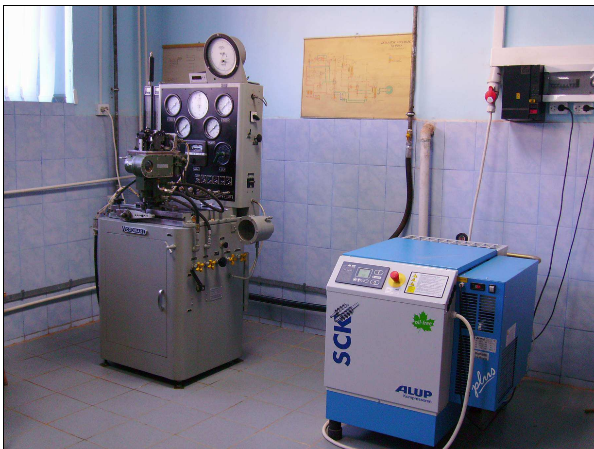
Fig.2.20. – Stand de reglatoare Woodward și instalație de producere și preparare aer instrumental
