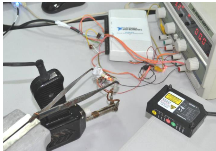
Figura 6. 14 Poziționarea traductorului de deplasare cu fascicol Laser
